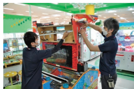
当社電気工事士による遊戯機械のLED化
